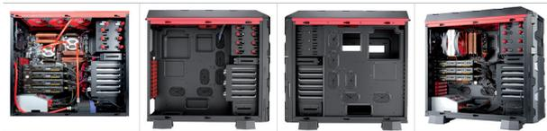
Beengte Verhältnisse nehmen einem schnell die Lust am Aufrüsten. Damit das nicht passiert, bietet das Interceptor-Gehäuse Platz für Mainboards mit HPTX-Formfaktor. Zahllose Kabeldurchführungen und das Kabelmanagement auf der Gehäuserückseite sorgen für zusätzliche Ordnung im Gehäuse.
