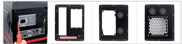
Das Interceptor Pro ist absolut flexibel. Je nach Bedarf können verschiedene Flexblenden im oberen Teil des Gehäuses montiert werden.
