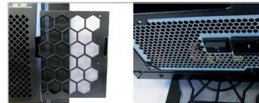
Um das System lange leistungsfähig und leise zu halten, fördern alle saugenden Lüfter nur gefilterte Frischluft in das Gehäuseinnere. Diese Filter lassen sich ohne großen Aufwand herausnehmen und auswaschen.
